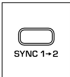
**SYNC 1->2** - オシレーター2 のオシレーターシンクを有効にし、オシレーター1 の位相に同期させます。オシレーター2 のピッチが オシレーター1 より高くなるにつれて、**SYNC** の効果はますます顕著になり、オシレーター 2 が オシレーター1 の位相に強制的に合わせるようになるため、倍音がより豊かな音色が得られます。
