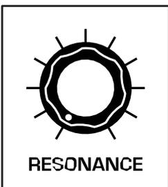
**RESONANCE - FILTER** のカットオフ周波数を強調し、レゾナンスを作り出します。完全に時計回りに回すと、**RESONANCE** は自己発振点に達し、サイン波を生成します。
