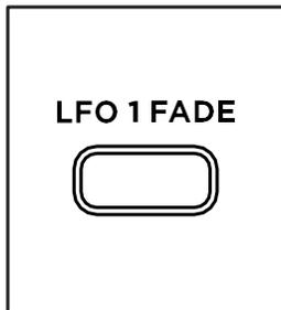
**10 - LFO 1 FADE** - **LFO 1** のフェードイン/フェードアウト動作を選択します。ネガティブの値(ボタン **1 ~ 8**、または **TEMPO** を**12** 時より下に設定する)では、最大**10** 秒のアタックが **LFO 1** に適用され、キーが押されるたびに **LFO 1** がフェードインします。ポジティブの値(ボタン**9-16**、または**TEMPO** が**12** 時を超える設定)は、最大**10** 秒間、**LFO 1** に対してディケイエンベロープのフェードアウトを適用します。フェード動作はデフォルトではオフになっており、**TEMPO** を**12** 時に設定することで無効にすることができます。この設定はパッチごとに保存されます。
