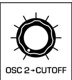
**OSC 2 -> CUTOFF - OSCILLATOR 2** を用いて フィルター の カットオフ周波数をモジュレーションし、かすかなフィルターのビブラートから、独自のチューニングによるオーディオレートのFMまでを生み出します。
