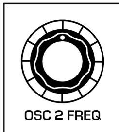
**OSC 2 FREQ** - オシレーター2 の周波数を オシレーター1 からデチューンします (TUNE コントロールからのオフセットに相対)。-7 半音から+7 半音の範囲で設定可能です。
