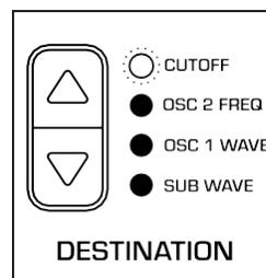
**DESTINATION** - LFO 1の宛先を選択します - **FILTER**の**CUTOFF**、**OSC 2**の**FREQUENCY**、**OSC 1**の**WAVESHape**、または**SUB OSC**の**WAVESHape**のいずれかです。
