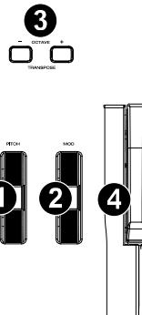
4. **Clavier** : Le clavier sensible à la vélocité n'est pas seulement la principale méthode d'envoi de notes On / Off et des données de vélocité lors de l'exécution, il est également utilisé pour accéder aux fonctions de programmation étendues répertoriées le long de son bord supérieur.
