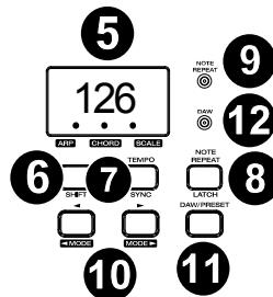
**11. DAW/PRESET :** lorsque ce bouton est enfoncé, il active la fonctionnalité Preset ou DAW du clavier sur les Faders, les boutons, les boutons et les pads.
