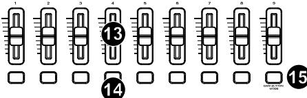
Mode DAW : Envoie des messages de fader de canal pour les faders de piste ou d'autres commandes DAW.
