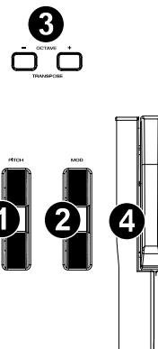
4. **Teclado:** El teclado sensible a la velocidad no solo es el método principal para enviar notas de activación / desactivación y datos de velocidad durante la interpretación, sino que también se utiliza para acceder a funciones de programación extendidas enumeradas a lo largo de su borde superior.
