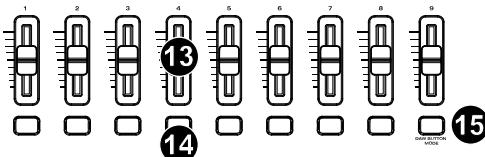
**DAW-Modus:** Sendet Kanal-Fader-Nachrichten für Track-Fader oder andere DAW-Steuerelemente.
