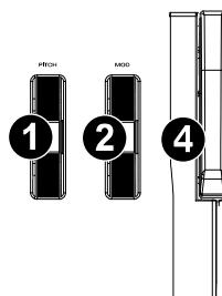
Spostando la ruota Modulation verso l'alto si aumenta l'effetto di modulazione, mentre spostandola verso il basso si riduce l'effetto.
